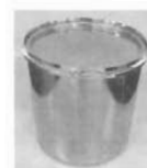
(3) 模擬容器外観写真 (20ℓ : φ300×H300mm)
